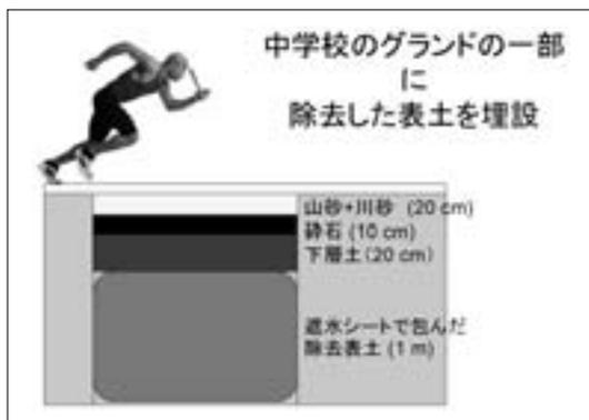
同じになるようにきれいな土を外から持ってきて載せます。校庭としての機能を損なわないという方針です。写真は遮水シートで表土を覆っている埋設の様子です。これから表面に土を載せます。溝を切っているのは、遮水シートのために水たまりができやすくないように、水はけを良くするための排水管を配管します。このようにグラウンドの下に汚染した表土を埋めているわけです。表土を取る前の放射線量率の分布をみますと、だいたい $2.5\sim 3.0\mu\text{Sv/h}$ になっています。傾向としてはグラウンドの真ん中あたりが高い。表土を取った
